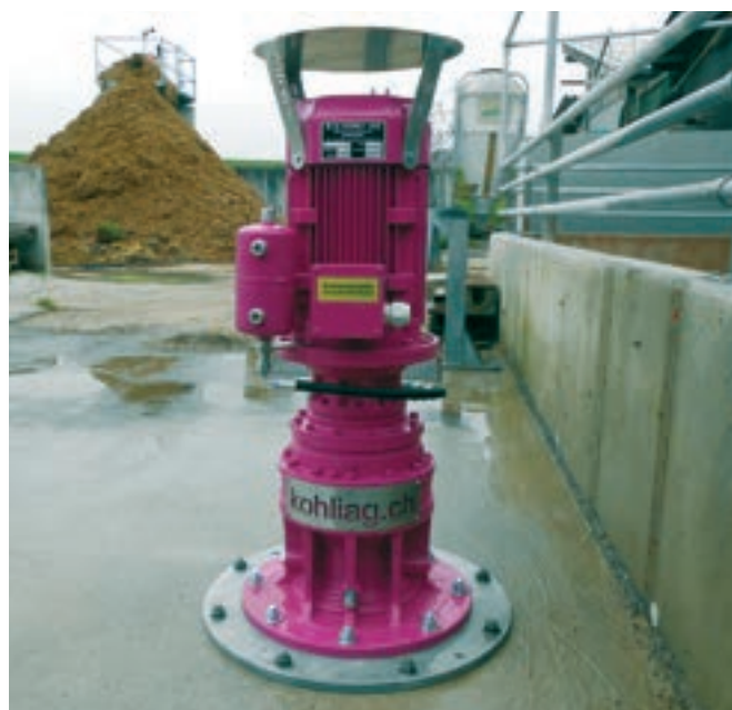
Fixée sur le couvercle de la fosse ou sur un socle en béton.
