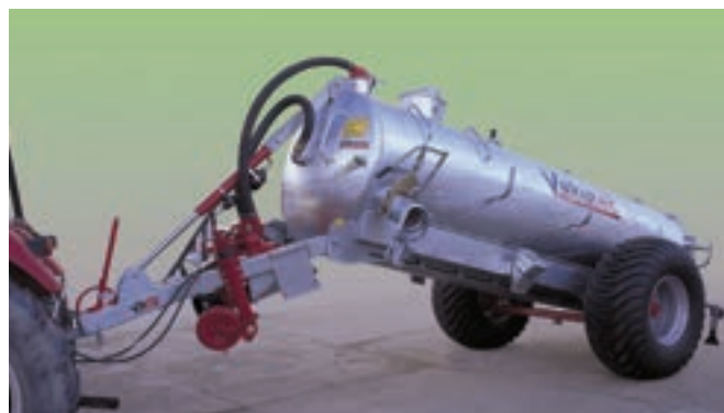
Timon Vario Réglage en continu de la hauteur du timon de traction.
