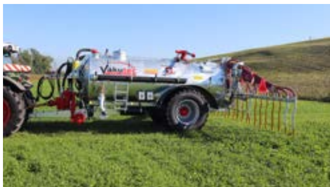
Citerne Vakutec version combinée 6500 l avec buse d'éjection hydraulique Vario, essieu réglable, dôme de remplissage, échelle d'accès, débitmètre, etc.
