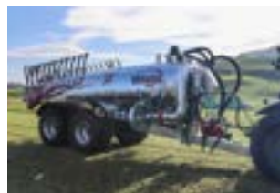
Citerne à vide/tandem 12 500 l avec bras d'aspiration et turbo-remplisseur (combinaison)
